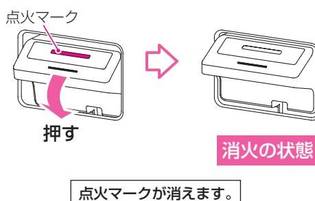
※レンジフードファンは、消火操作から約3分後に自動停止または常時換気となります。(レンジフードのタイプにより、常時換気のない場合があります。詳細はレンジフードファンの取扱説明書を参照してください。)
